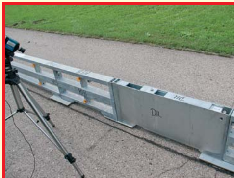
Kipplängenbegrenzer (KLB) für ProTec 50 und Dilatationselement
